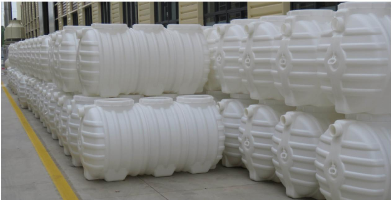
隔板：将直流水转成环流水，增加污水在池体内的滞留时间，使污水在池内与沉淀污泥的解除时间更长，产生更多的微生物，对污水进行分解吞食。过滤器处理区：采用先进的生物膜法处理技术，在此区域内经过一定时间的培育，大量微生物在过滤器表面繁殖形成生物膜，污水与过滤器表面的生物膜接触，污水中的有机物被微生物截留流，吸附和分解，从而实现对污水的有效净化处理。工厂一体化生产，一次整体成形，施工现场一次性吊装到位，半天即可完成安装，\*\*提高了施工效率，缩短建设周期，提高了经济和社会效益。产品结构紧凑，占地面积小，实际占地面积为传统化粪池的60%左右，节约土地资源。注塑化粪池外观为圆筒形设计，筒体两端采用力学凹凸面设计制作，筒体本体采用环向密集波纹体曲面结构设计制作，抗压强度承载能力高，施工完毕后该产品上方可承载30t载重汽车通行。
